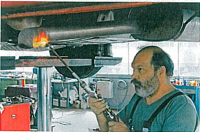
Das solide, selbst gebaute Motorschutzblech und der – zugegeben – eher rustikal höhergelegte Auspuff sollen die Folgen lindern, falls trotz Umrüstung auf 18-Zoll-Pneus der Boden zu nahe kommt.
