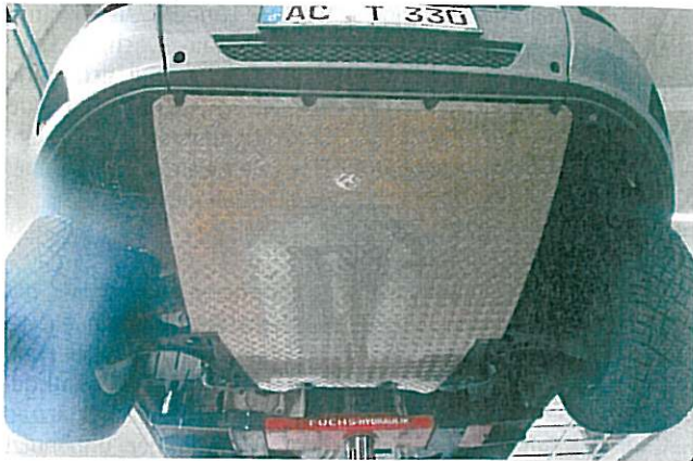
Das solide, selbst gebaute Motorschutzblech und der – zugegeben – eher rustikal höhergelegte Auspuff sollen die Folgen lindern, falls trotz Umrüstung auf 18-Zoll-Pneus der Boden zu nahe kommt.
