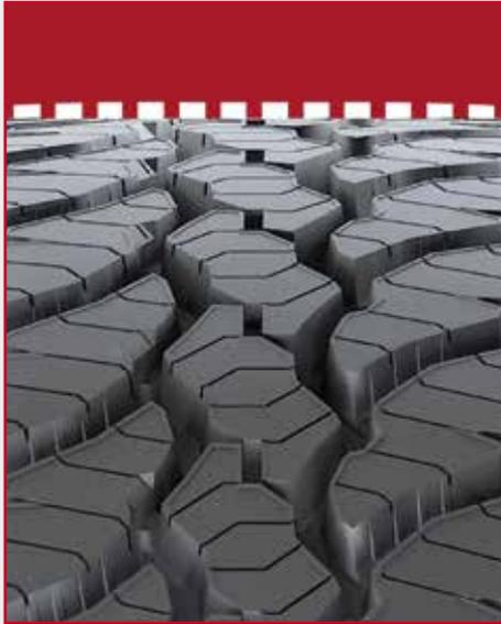
Profitieren Sie von einer langen Laufleistung durch eine breite, flache Laufflächenkontur, die gleichmäßige Druckverteilung und dadurch gleichmäßigen Abrieb bewirkt.
